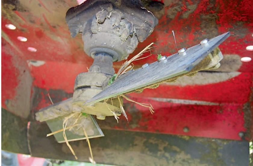
Das Messer mit einem steilen Anstellwinkel schneidet das Pflanzmaterial ab
