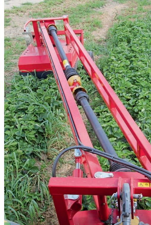
Der Antrieb erfolgt über Zapfwellen
