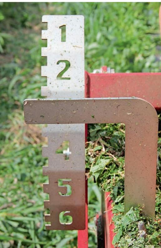
Die Einstellung der Höhe des Geräts ist vom Schlepper aus gut sichtbar
